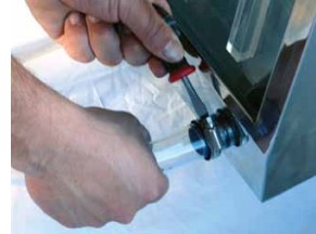
ステップ 3-4: 完全にチューブが排水口に差し込まれているかどうか、必ず確認して下さい。
