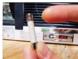
3. 新しいフューズ (250ボルト、 15アンペア スローブローフューズ) のフューズに取り替えます。
