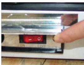
1. 電源の左側にある フューズホルダーを押しながら 反時計回りに回して下さい。
