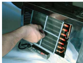
ステップ 3-2. フィルターをコンデンサーから取り外します。
