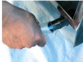
ステップ 3-3: 排水口の中にチューブを差し込みます。
