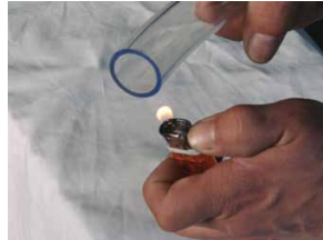
ステップ 3-2: ライターでチューブの最端をやわらかくします。(注意: 熱しすぎないで下さい。)
