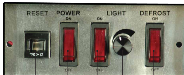
ブレーカ 電源スイッチ LEDライトスイッチ LEDライトコントロールスイッチ デフロスト制御スイッチ
